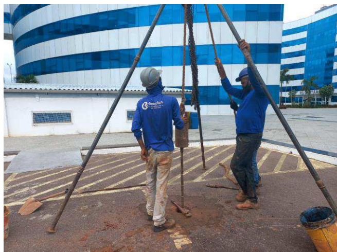
Foto 4 - Ensaio de resistência do solo (peso em queda livre)
