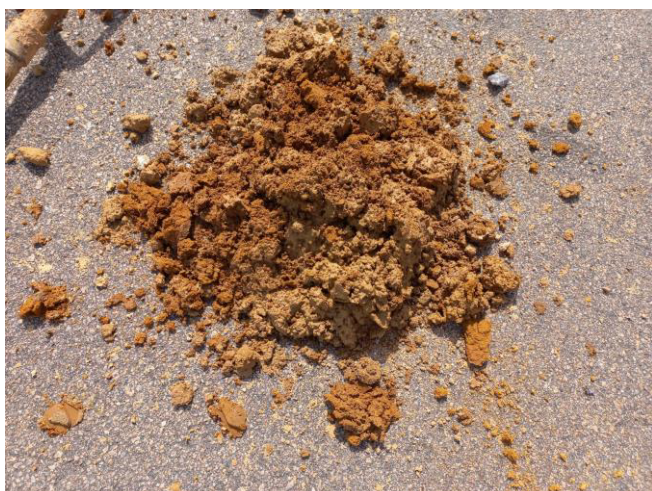
Foto 5 - Aterro cascalho laterítico argiloso
